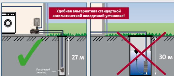
\* Конструкция JPA PT имеет встроенный эжектор и не требует второй трубы на всасывание.
